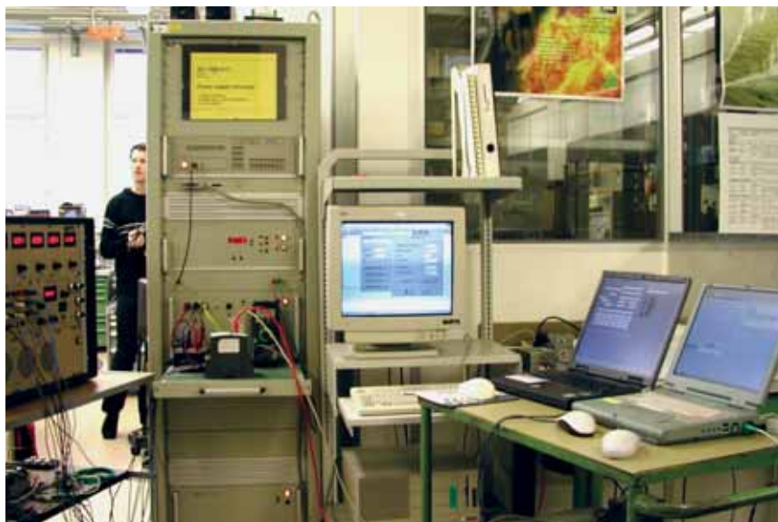
Messung des Verhaltens der Geräte bei Spannungseinbrüchen, Kurzzeitunterbrechungen oder Spannungsschwankungen der Hilfsenergieversorgung
